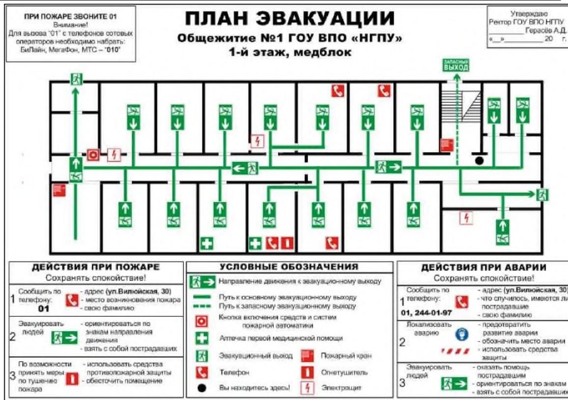
Рис. 7. Образец плана эвакуации.
