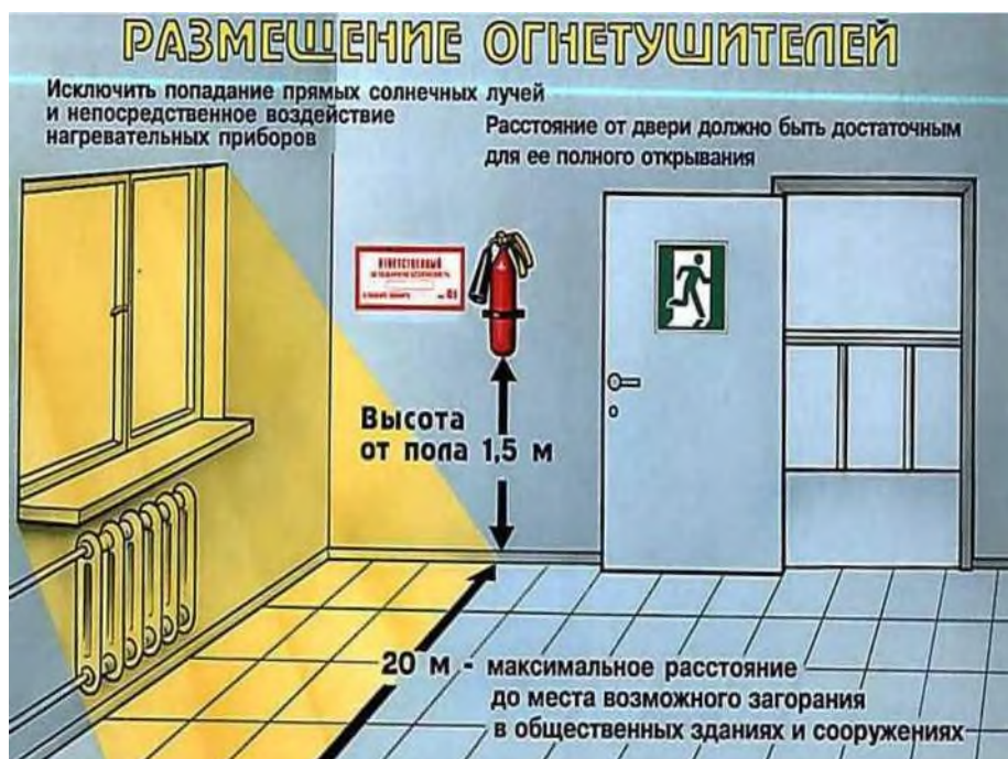
Рис. 10. Требования к размещению огнетушителей.
