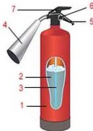
Рис. 8. Конструкция переносного углекислотного огнетушителя. 1 - корпус; 2 - заряд ОТВ (двуокись углерода); 3 - сифонная трубка; 4 - раструб; 5 - ручка для переноски; 6 - предохранительная чека; 7 - запорно-пусковое устройство.
