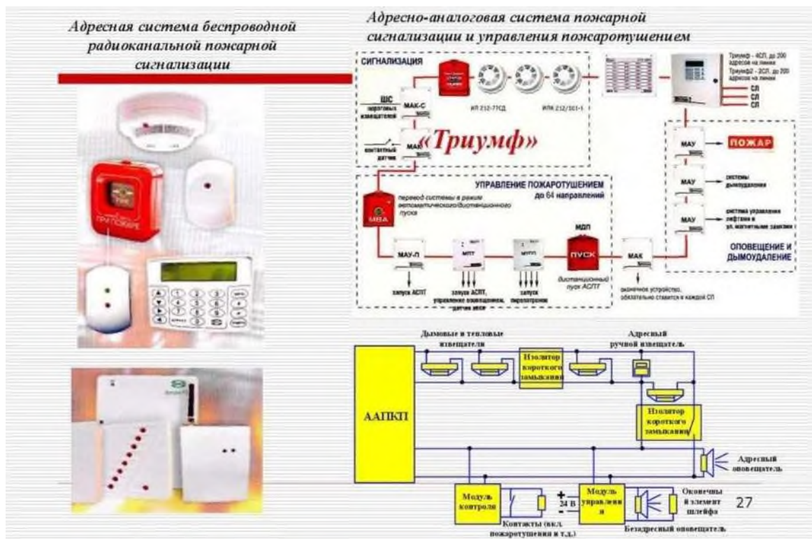
Рисунок 4. Адресная система пожарной сигнализации
