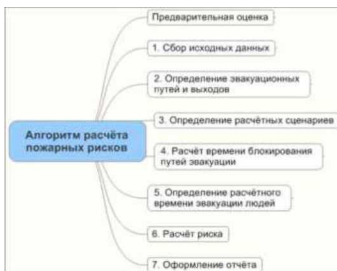
Рис. 2. Алгоритм расчета пожарных рисков.
