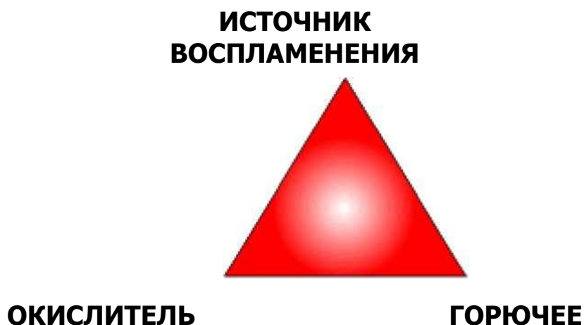
Рис. 1 Классический треугольник пожара.
