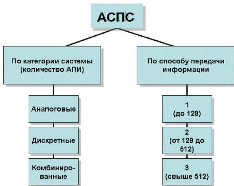
Показ презентации по адресным системам пожарной сигнализации, интегрированным системам безопасности и аспирационным пожарным извещателям. Адресная система пожарной сигнализации (АСПС) представляет собой совокупность ТС пожарной сигнализации, предназначенных (в случае возникновения пожара) для автоматического или ручного включения сигнала «Пожар» на адресном приемно-контрольном приборе посредством автоматических или ручных адресных пожарных извещателей (АПИ) защищаемых помещений.
