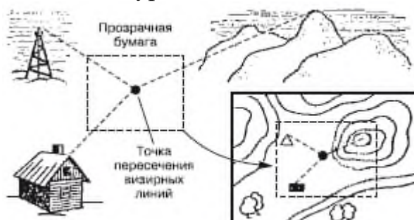
Рис. 6.20. Ориентирование способом Болотова
