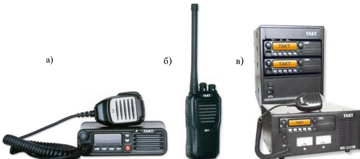
Рис. 9 Радиостанции комплекса Такт: а) – радиостанция Такт-201; б) – радиостанция Такт-301, в) – стационарный радиокomплекс Такт.
