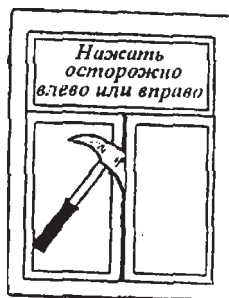
Рис. 4.4. Открывание оконной рамы
