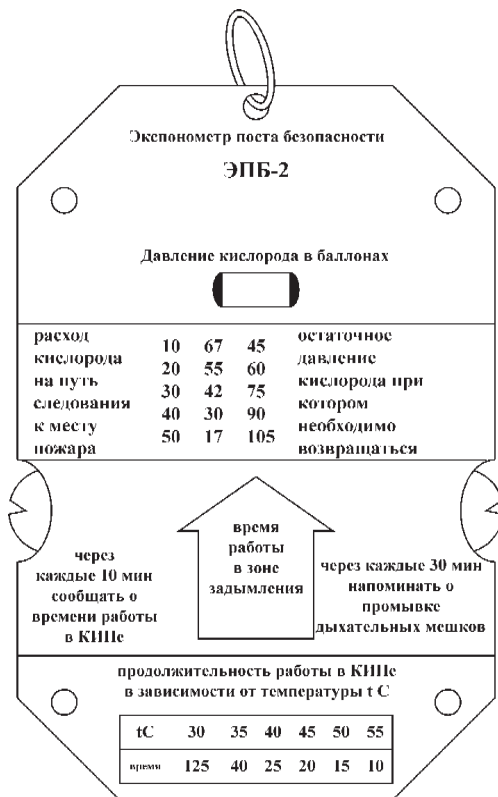
Рис. 8.5. Экспонометр поста безопасности ЭПБ-2
