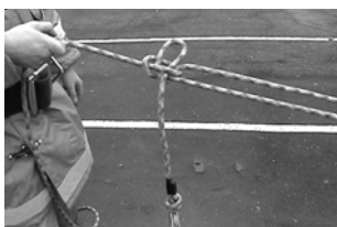
Рис. 6.3. Закрепление спасательной веревки вторым способом
