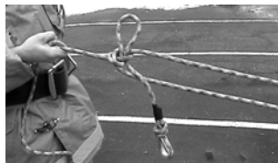
Рис. 6.4. Закрепление спасательной веревки третьим способом
