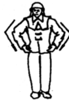
Рис. 5. Подать пенный пожарный ствол
