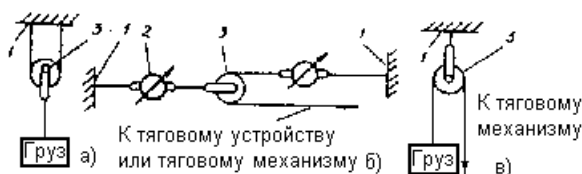
Рис. 4.3. Схема испытания однорольных блоков:
