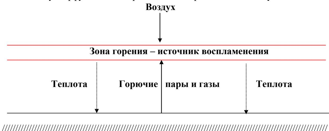
Из приведённой схемы видно, что диффузионное горение может происходить при следующих условиях:
